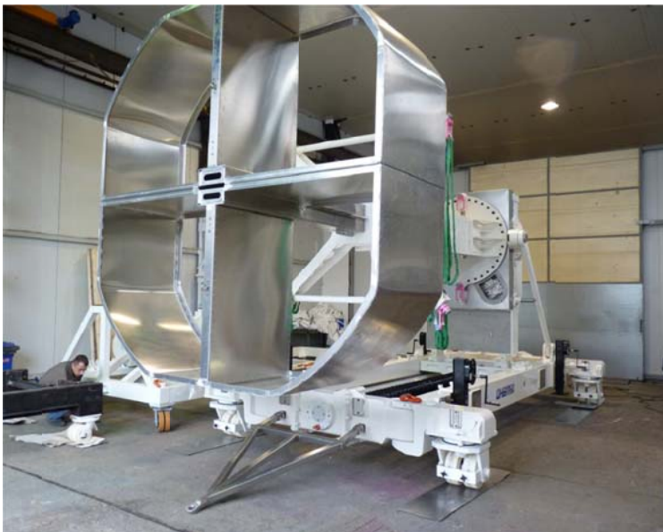
Der MPT mit einem Massen-Dummy des zukünftigen Satelliten in horizontaler Position.
